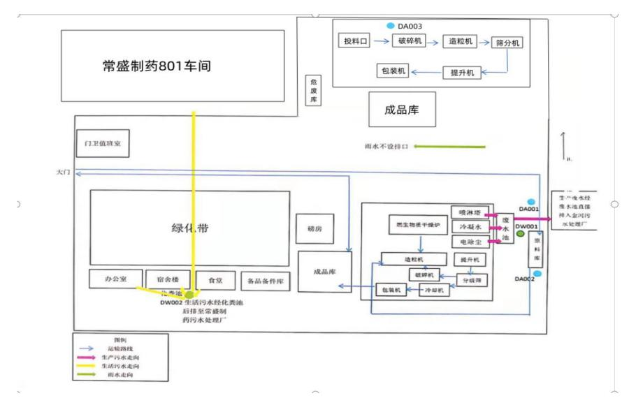
厂区雨污管线走向图
